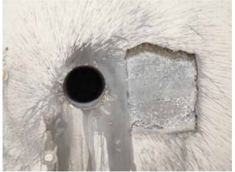
Şekil 8 - Beton Çekici okumaları için hazırlanmış bir yüzey ve yanı başında alınmış bir karot numunesi (tahribatlı yöntem) yeri
