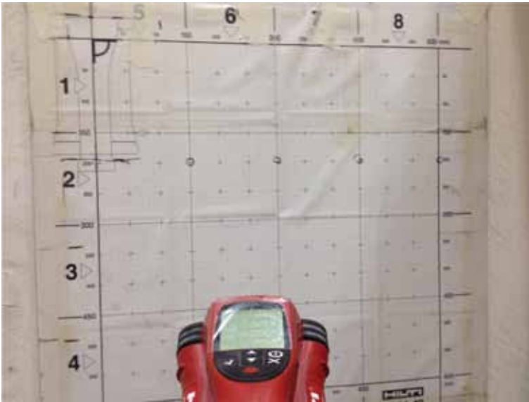
Şekil 2 - Kolonda donatı düzeninin röntgenle belirlenmesi
